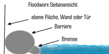
Die Bremse ist mit Wasser konfrontiert, wenn die Barriere gegen eine flache Oberfläche (Tür oder Wand) gerichtet ist.
